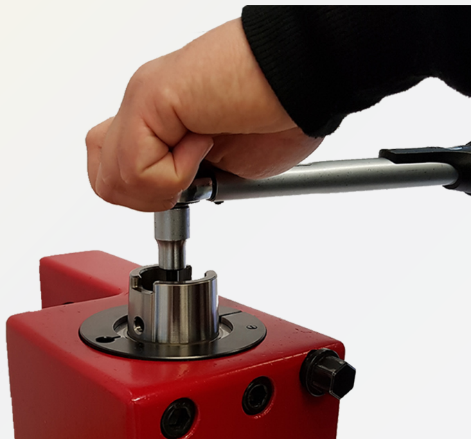
Abb. 7: Spannhülse mit dem Drehmomentschlüssel anziehen
