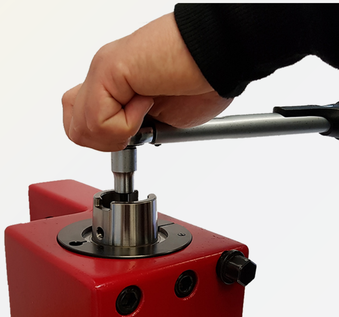
Abb. 11: Spannmutter mit dem Drehmomentschlüssel anziehen
