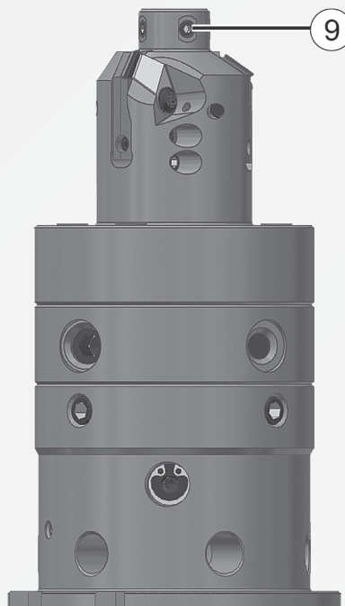
Abb. 32: Schrauben am Bund des Werkzeuges lösen
